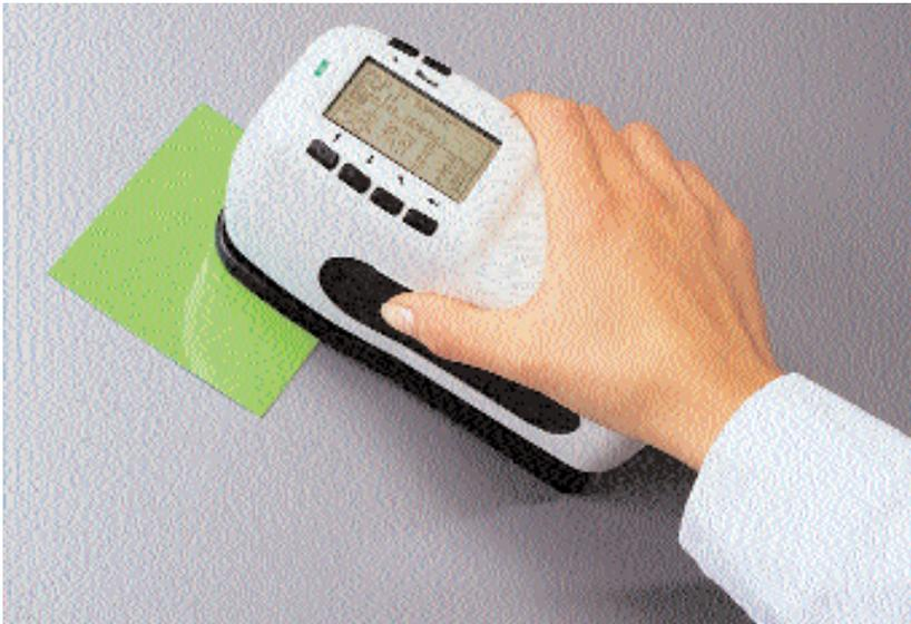
Modernes Farbmessgerät (SP60 von X-Rite)
